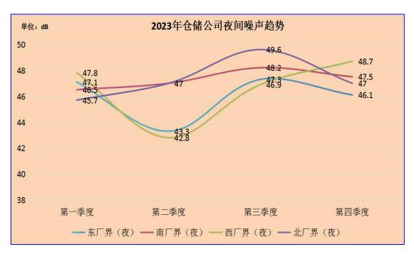
夜间噪声:东厂界平均值为 45.95dB,南厂界平均值为 47.3dB,西厂界平均值为 46.55dB,北厂界平均值为 47.325dB,相较于 2022年有一定升高。分析原因:今年相对去年装卸车、装船等频次增多,机泵运转频繁,且新增制氮机,产生噪声的源头增多,故造成噪声有一定的提高。
