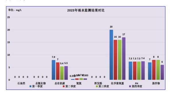
本年度雨水各污染物检测值较为稳定,无超标现象,监测污染物有:石油类、总氰化物、总有机碳、氨氮、挥发酚、化学需氧量、PH、悬浮物。全年石油类平均值、挥发酚、总氰化物均未检出,总有机碳平均值为 6.45mg/L,氨氮平均值为 0.557mg/L,化学需氧量平均值为17.25mg/L,PH 平均值为 7.3,悬浮物平均值为 7.25mg/L。
